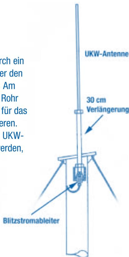
Für den Blitzschutz (Fangeinrichtungen, Ableitungen, Erdung) dienen auf einer Segelyacht Mast(en), Wanten, Vorstag, Achterstag, sowie Besanmast mit den Stagen und Wanten, die in der Regel mittschiffs mit der Erdungsplatte verbunden sind. Für Motoryachten gilt, wenn ein Rigg vorhanden ist, das Gleiche.
